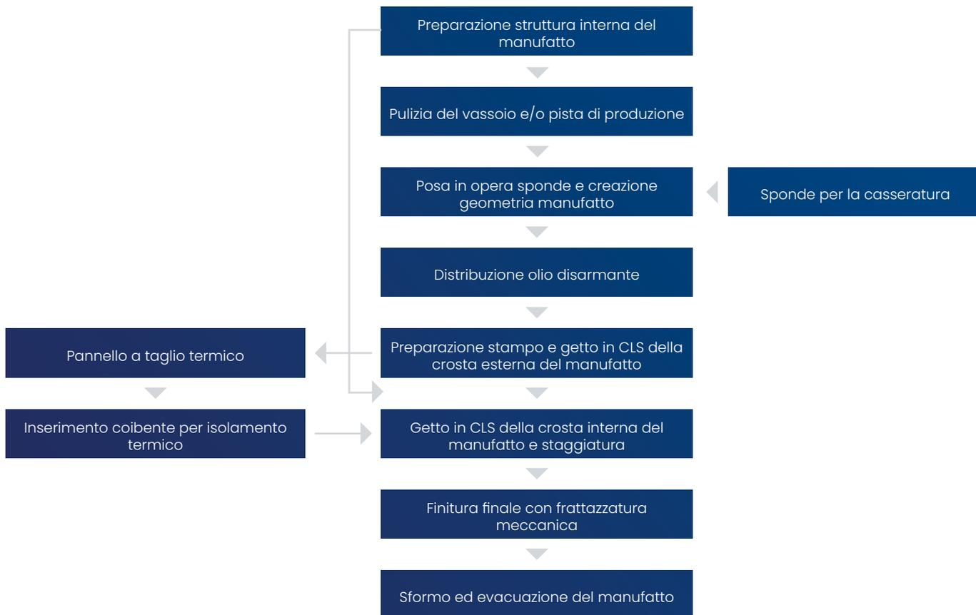
Figura 3: Schema ciclo produttivo pannello prefabbricato Manini
