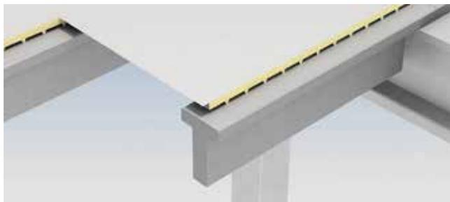
Sistema costruttivo prefabbricato composto da pilastri, travi in cemento armato precompresso e travi secondarie con sezione a T, anch'esse realizzate in cemento armato precompresso
